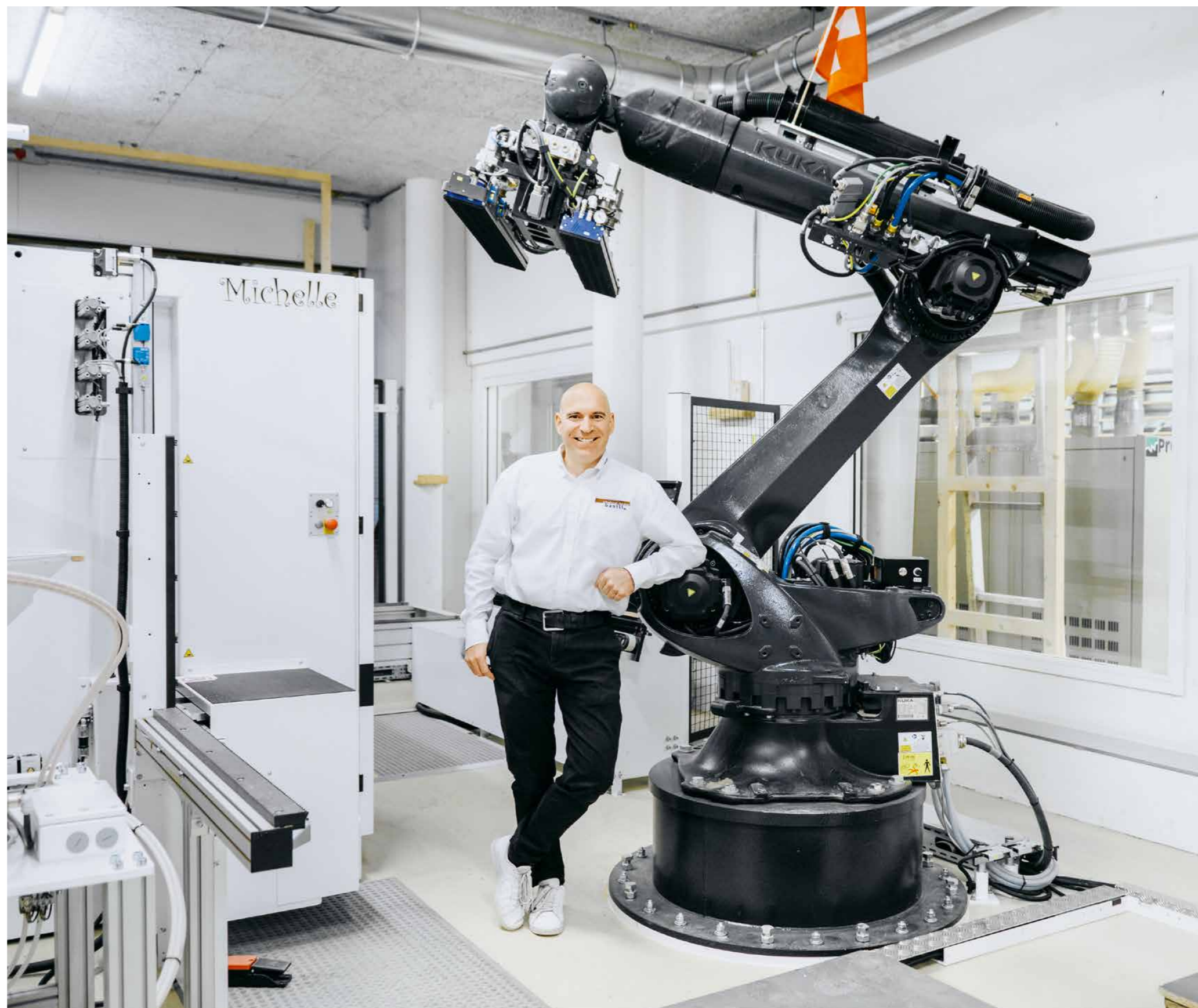
Oliver Bantli, titolare della Schreinerei – Holzbau Bantli AG di Eschenz TG, si trova di fronte a «Michelle», un CNC verticale con braccio robotizzato per parti di cassa.
