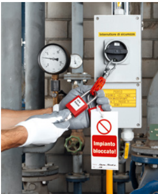
Regola 3 Disinserire e mettere in sicurezza l'impianto
